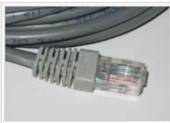
Cablu bifilar torsadat și conector Standardul 10BASE-T
