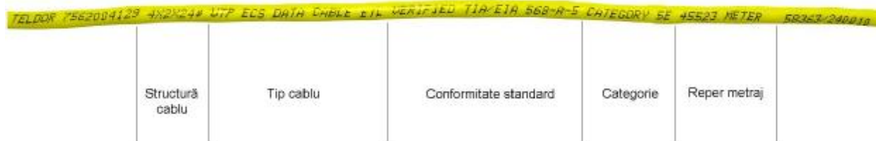
Fig. 2 – Marcarea cablului UTP
